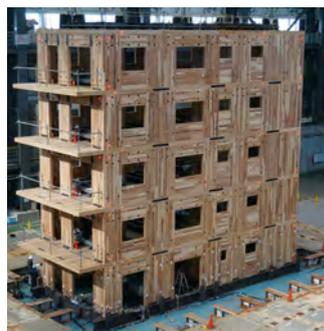
CLT パネルを用いた建築物の構造性能検証震動台実験（E-ディフェンス）
