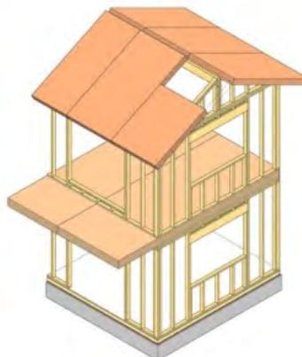
軸組壁工法+CLT
